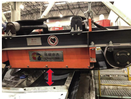
图 8 永磁式除铁器高度调整
